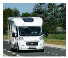
utilisé fut un EUROPEO 91 P, équipé d'un moteur Fiat JTD 3.0, sur un parcours varié de 100 km, alternant autoroute, nationale, plat et route vallonnée. Ce parcours fut réalisé une première fois avec la modification, puis il fut refait en suivant, avec la cartographie d'origine. Le résultat était là : en plus de l'agrément de conduite indéniablement renforcé, le véhicule avait enregistré un gain de consommation de 6,5%.
