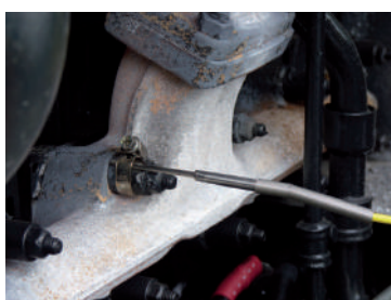
Durant tout l'essai d'optimisation, la surveillance de la température des gaz d'échappement a permis de vérifier qu'elle restait dans des valeurs normales.
