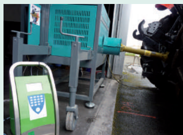
Après relèvement de la puissance, l'analyseur d'oxyde d'azote ne laisse pas apparaître de variation dans les niveaux d'émissions.
