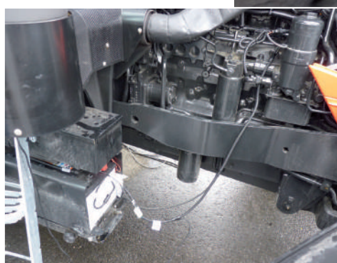
Sur les tracteurs récents, Sport System propose de brancher un boîtier électronique sur le réseau bus CAN. Celui-ci prend le relais de l'unité centrale contrôlant le moteur.
