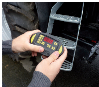
Grâce à son petit terminal portatif, le technicien programme les paramètres de correction.
